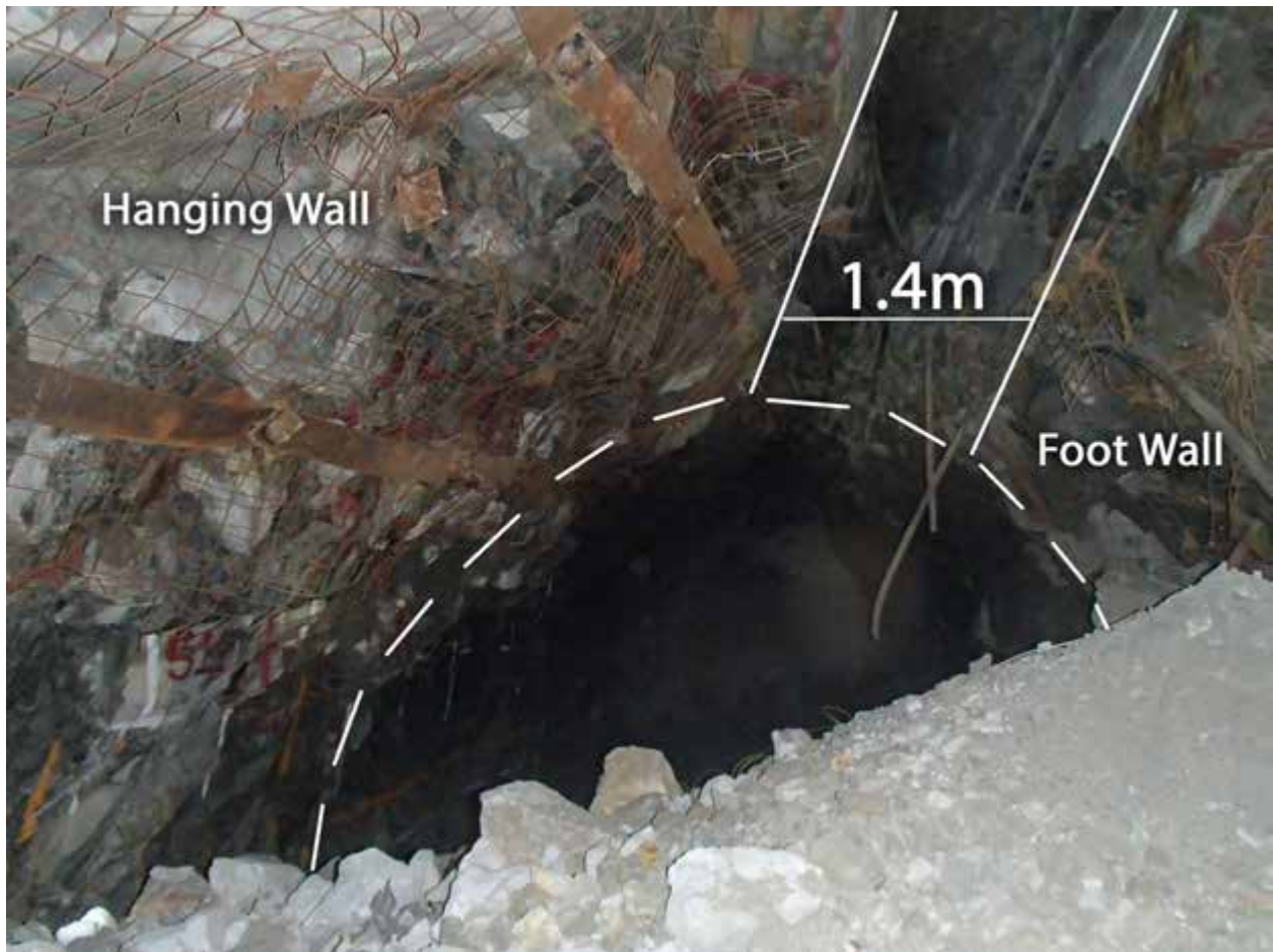
Figura 3: Fotografía del rebaje de prueba que demuestra el excelente control de explosión aproximadamente a 1.4 metros de ancho horizontal en esta ubicación y buena fragmentación de roca por debajo.
