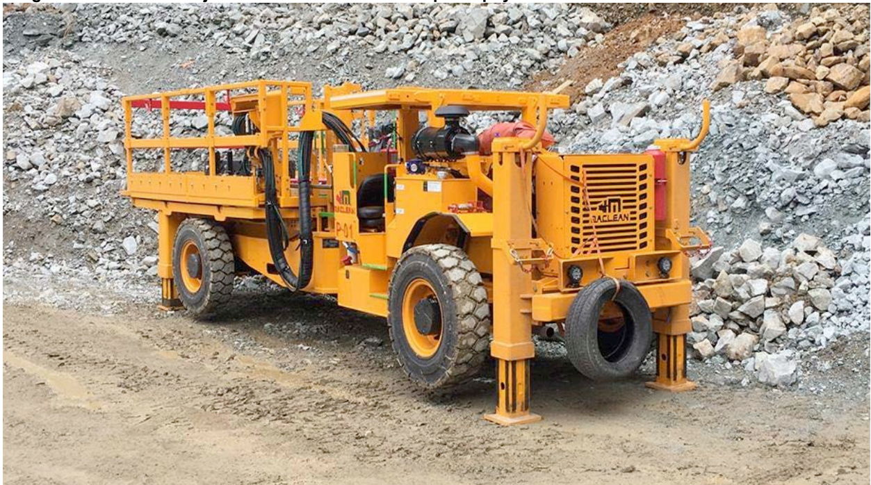
Imagen 5: Elevadora de tijera recientemente instalada para apoyar el desarrollo subterráneo
